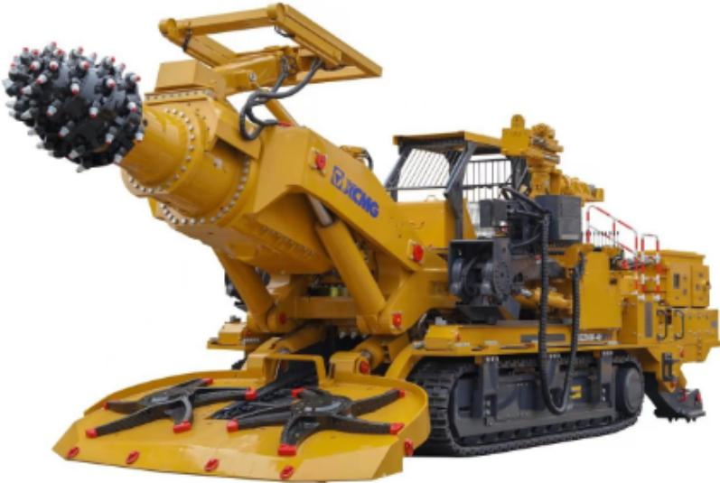
截割煤岩时应注意以下事项：（1）岩石硬度大于掘进机切割能力时，应停止使用掘进机，并采取其它破岩措施。（2）根据煤岩的软硬程度掌握好机器推进速度，避免发生截割电机过载或压死刮板输送机等现象，切割时应放下铲板。如果落煤量过大而造成过载时，司机必须立即停机，将掘进机退出，进行处理。严禁点动开机处理，以免烧毁电动机或损坏液压马达。（3）截割头工作必须在旋转状况下才能截割煤岩。截割头不许带负荷启动，推进速度不宜太大，禁止超负荷运转。（4）截割头在比较低工作位置时，禁止将铲板抬起。截割部与铲板的间距不得小于300毫米，严禁截割头与铲板相碰。截割上部煤岩时应防止截齿触网、触梁。（5）经常注意清底及清理机体两侧的浮煤（岩），扫底时应一刀压一刀，以免底部出现硬坎，以防止履带前进时越垫越高。（6）煤岩块度超过机器龙门的高度和宽度时，必须先人工破碎后方可装运。（7）当油缸行至终止时，应立即放开操作手柄，避免溢流阀长期溢流，造成系统发热。（8）掘进机向前掏槽时，不准使切割臂处于左、右极限位置。（9）装载机、转载机及后配套运输设备不准超负荷运转。（10）随时注意机械各部、减速器和电机声响以及压力变化情况。
